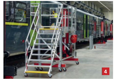
4. Mobile Seitenarbeitsbühne zum Bearbeiten der unteren Seitenbereiche
