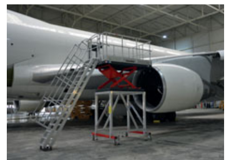
Hydraulisch höhenverstellbare Wartungsbühne
