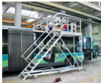
Schnell und garantiert sicher: Wartungsbühne mit Zentralfeststellung
