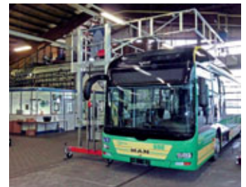
Robuste Einhausung: Mit Ausklappgeländer für zusätzlichen Schutz
